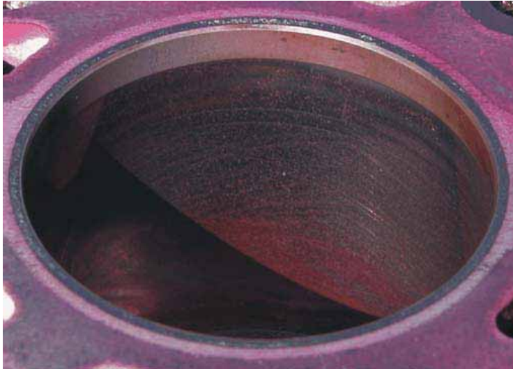
Bild 4-3: Digital bild av motorblocket i Ford Escort före behandlingen (heningsspår kunde observeras på cylinderytan)
